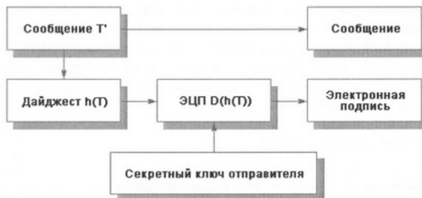
Рис. 2 – Схема установки ЭЦП.
